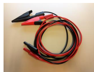
Fig. 1. Cableado de conexión y terminales de cocodrilo.
